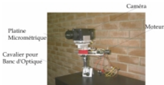
Figure 1. Montage global: la caméra est montée sur un banc d'optique. Une platine micrométrique permet un positionnement précis.
