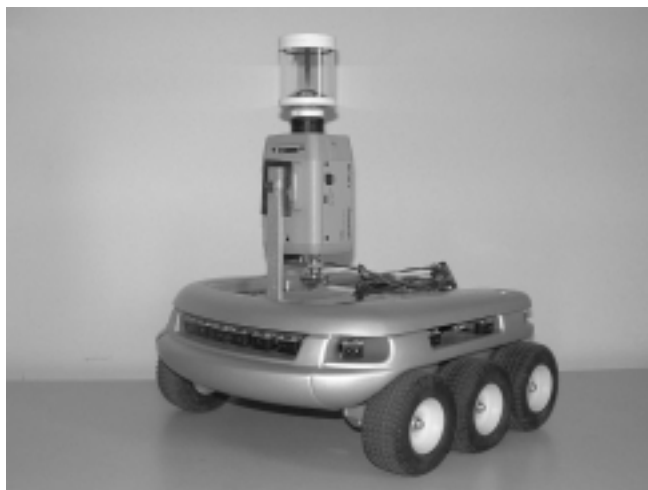
Figure 1. Un robot mobile muni d'une caméra panoramique (miroir parabolique).
