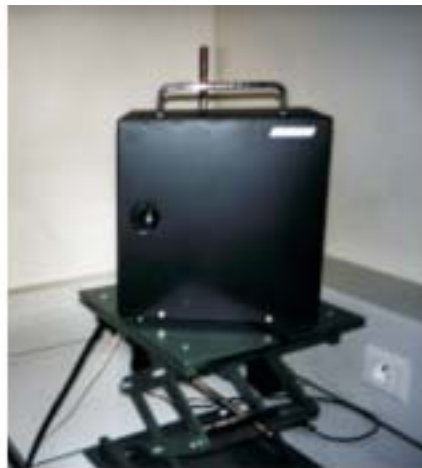
(a) La caméra multispectrale vue de l'extérieur Largeur : 26 cm ; hauteur : 34 cm ; épaisseur : 17 cm poids : 4,5 kg ; vitesse : 1 image multispectrale/seconde
