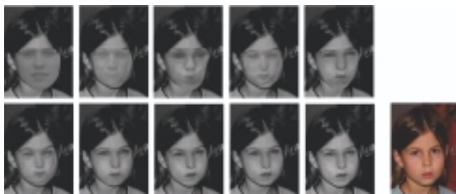
Figure 3. Adaptation itérative du modèle actif d'apparence, en partant d'une pose et d'une apparence proches du visage cible situé en bas à droite.
