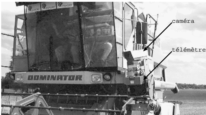
Figure 2. – Positionnement du capteur sur la moissonneuse batteuse.
