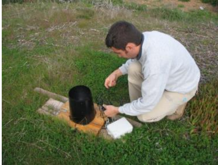
Figura 36. Descarga de los datos almacenados por el medidor de precipitación.
