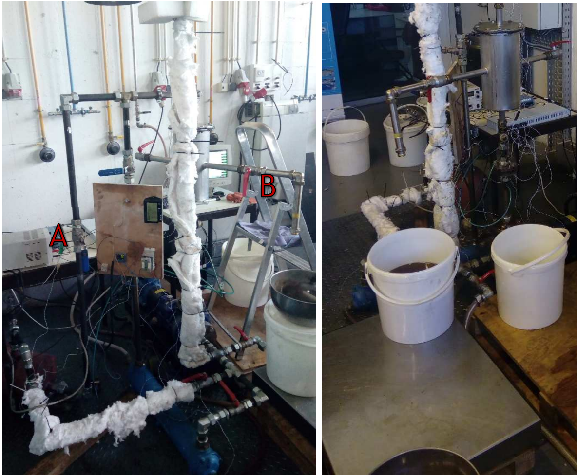
Figura D.2- Foto da instalação durante o processo de calibração da placa orifício.
