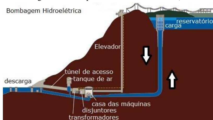
Figura 2.5- Esquema de funcionamento de uma planta de bombagem hidroelétrica (Guney e Tepe, 2017).
