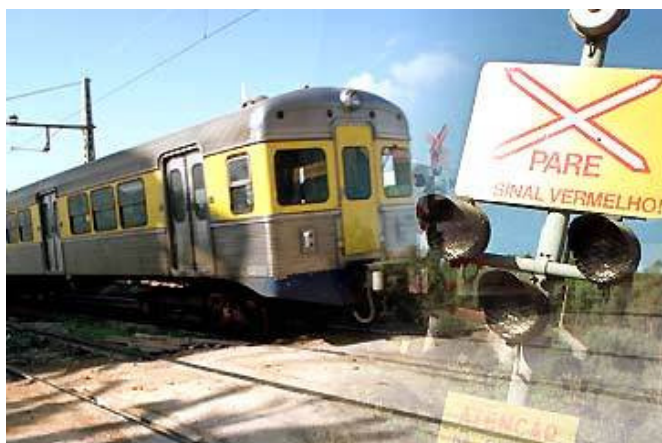
Fig. 3.14 – Passagens de Nível sem guarda (5ª categoria)
