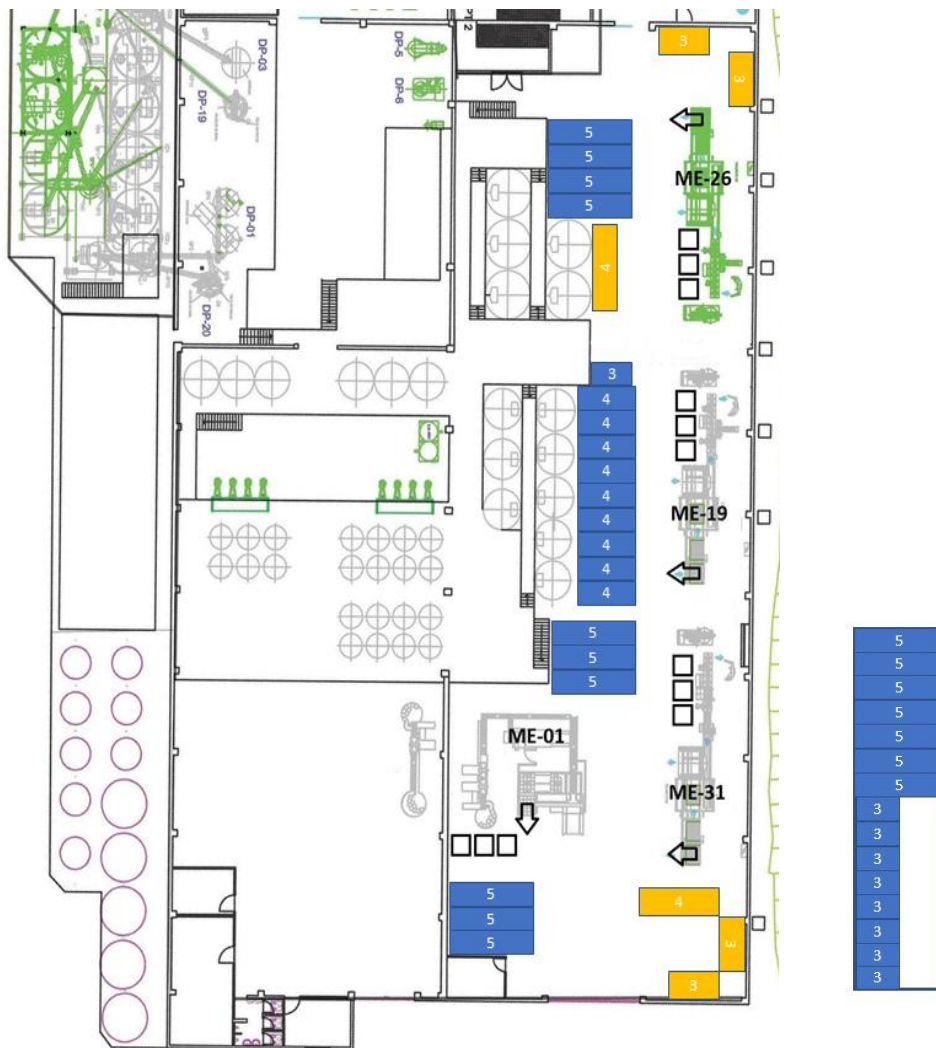
Figura 14 - Disposição do espaço disponível para armazenamento de embalagens e tampas. Layout interno à esquerda e corredor externo à direita.
