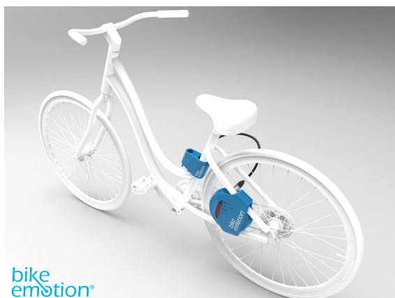
Figura 1.1: Dispositivo de localização e de bloqueio das bicicletas no BikeEmotion.
