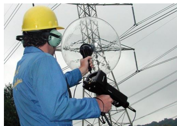
Figura 5.2 - Inspeção a linhas aéreas pela deteção de ultrassons propagados pelo ar [77]
