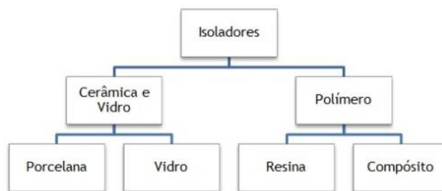
Figura 2.6 - Classificação dos isoladores de acordo com o material do dielétrico
