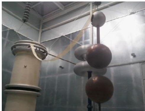
Figura 6.9 - Montagem das esferas de calibração [84]
