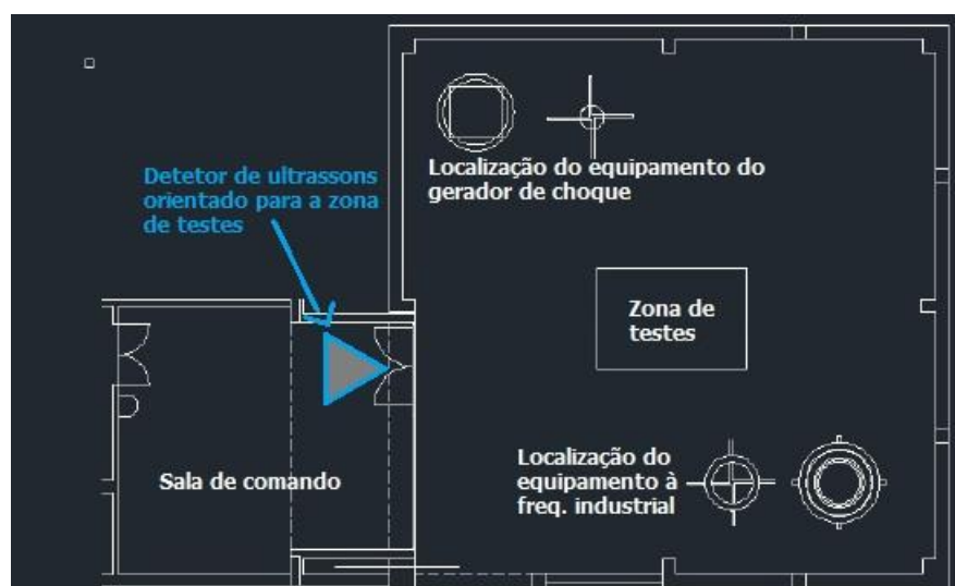
Figura 7.10 - Localização do detetor de ultrassons relativamente à zona de testes [22]
