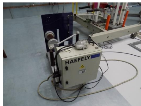
Figura 6.3 - Unidade de alimentação do gerador de choque
