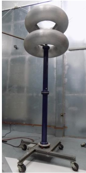
Figura 6.6 - Divisor de tensão utilizado em ensaios à frequência industrial
