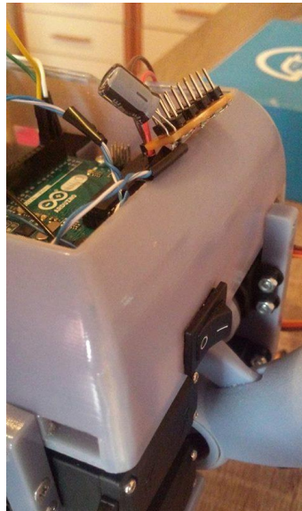
Slika 62. Sklopka za prekid strujnog kruga
