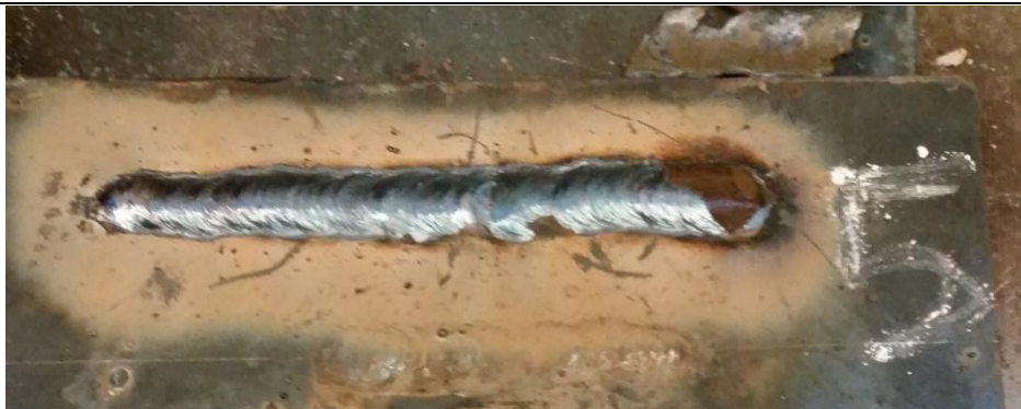
Slika 47. Zavar ispitnog uzorka 5 i ispitne ploče
