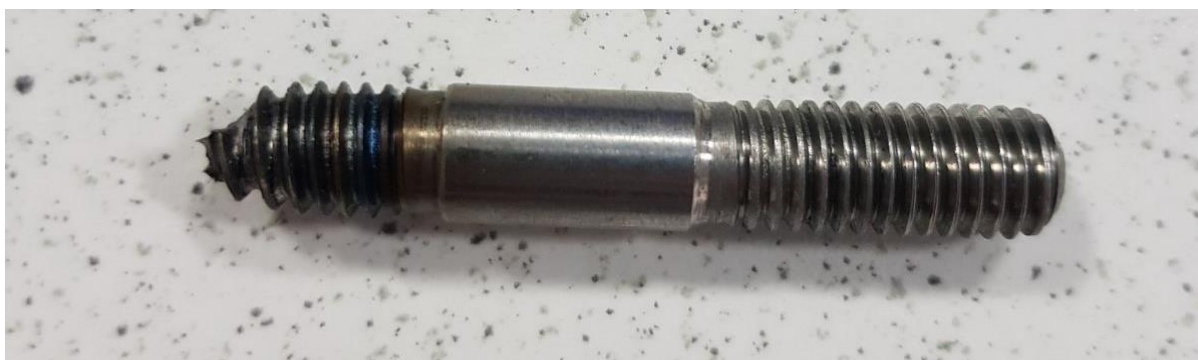
Slika 44. Ispitni uzorak broj 3 nakon loma
