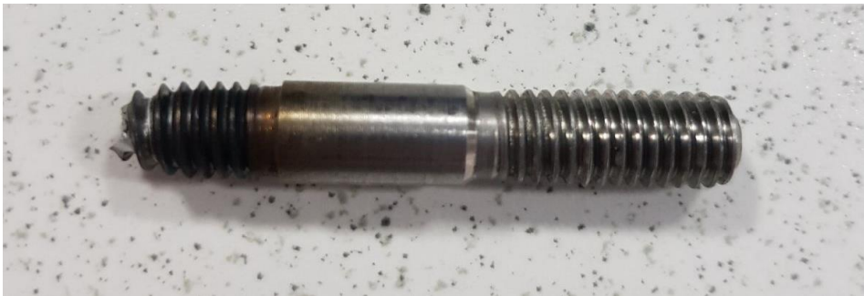
Slika 40. Ispitni uzorak 1 nakon loma
