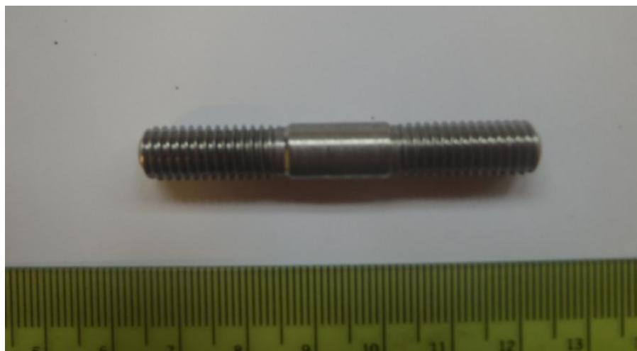
Slika 37. Implant uzorak s obostranim navojem
