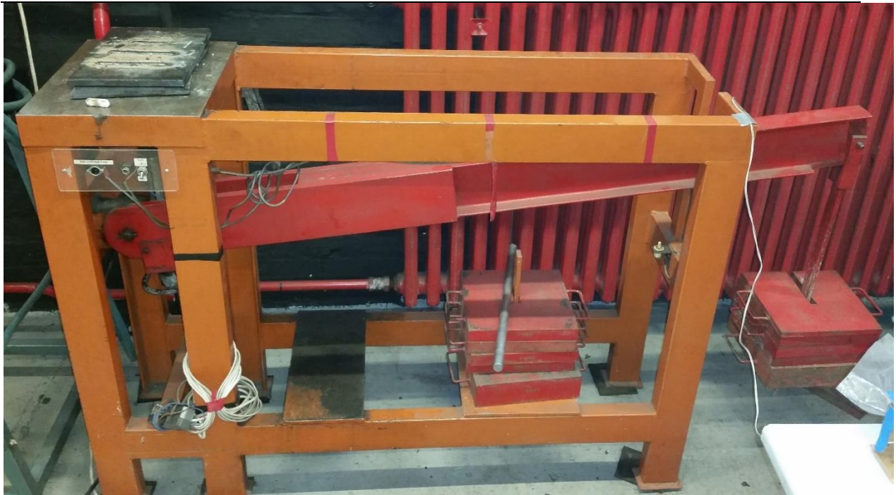
Slika 38. Prikaz Implant testa tijekom opterećenja epruvete
