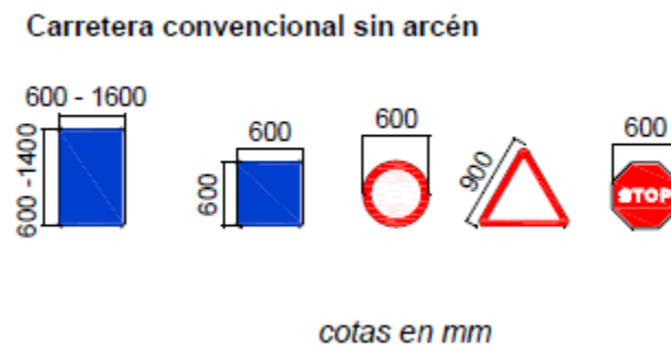
Figura 81. Dimensiones de señales de contenido fijo. (Fuente: Norma 8.1-IC).
