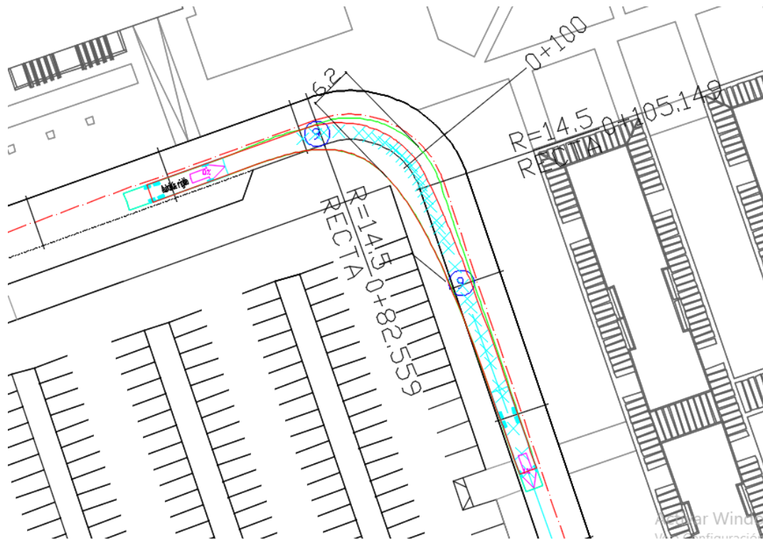
Figura A3.11. Giro envolvente de autobús rígido curva 1.1. Elaboración propia.
