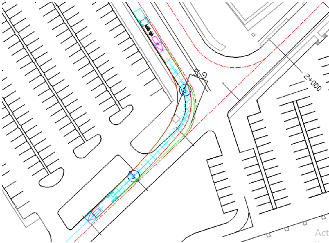
Figura A3.19. Giro envolvente de autobús rígido en Entrada Acceso Norte. Elaboración propia.
