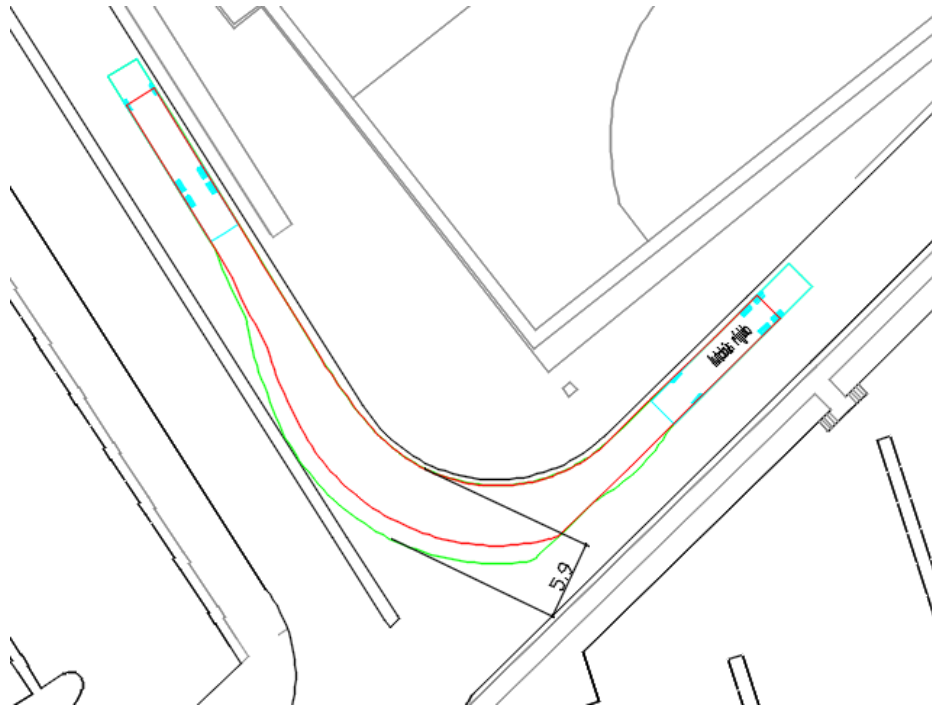
Figura A3.43. Giro envolvente en el Acceso Norte para la actuación de mejora de supresión de carril. Elaboración propia.
