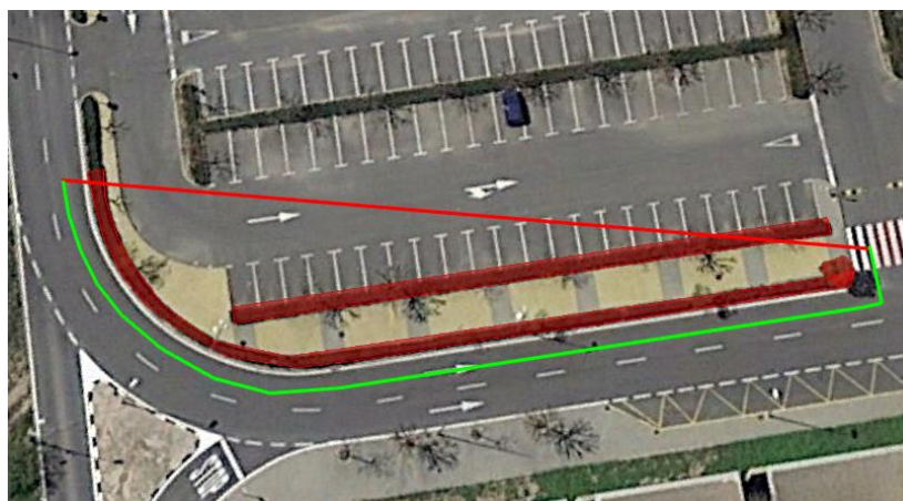
Eliminación de vegetación en el cruce 6.
