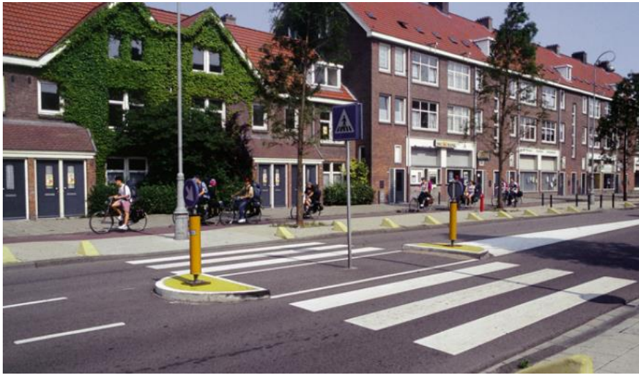
Figura 117. Refugio peatonal en paso de cebra. Amsterdam (Fuente: Calmar el tráfico).
