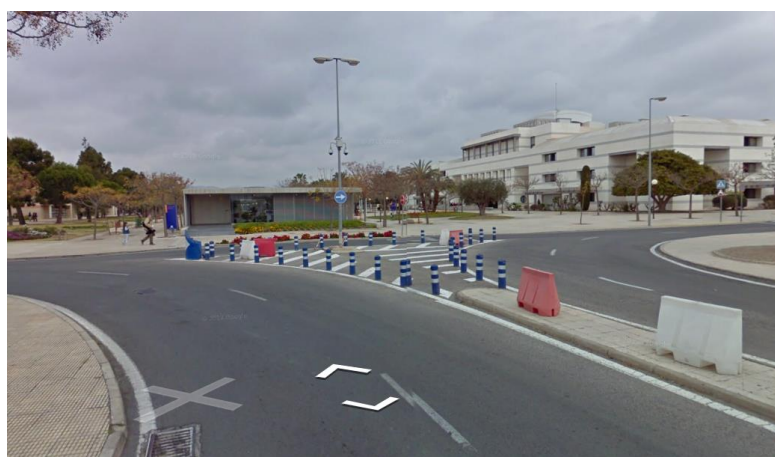
Figura 85. Hitos de vértice y balizas en isleta en el Campus. (Fuente: Google Street View).
