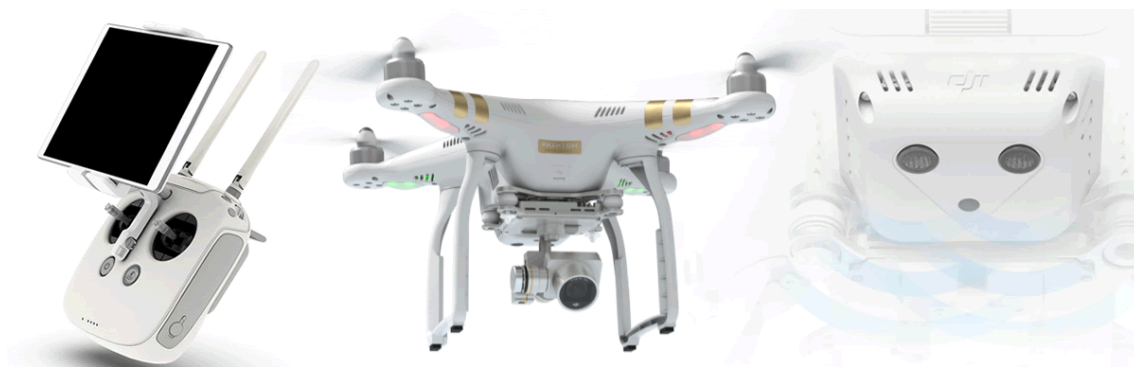
Figura 3.11: À esquerda: controlo remoto com duas antenas [70] - tecnologia lightbridge ; no centro: Phantom 3 em voo; À direita: sistema de posicionamento visual [71].
