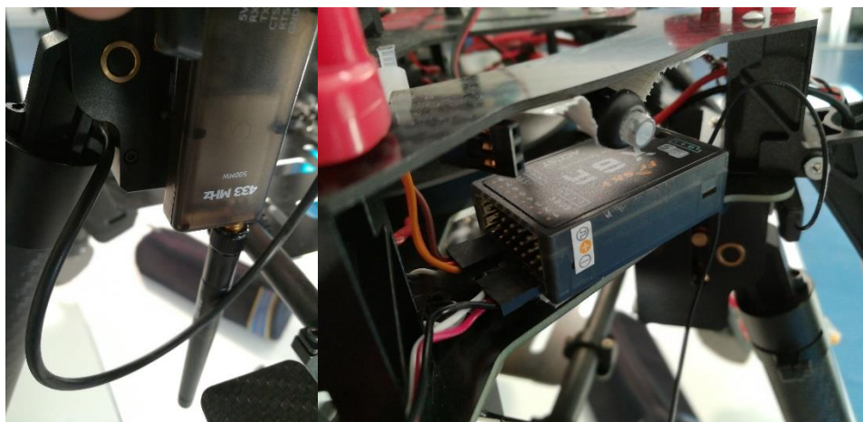
Figura 3.8: À esquerda: rádio para controlo remoto direto dos ESC; À direita: módulo de telemetria para comunicação com o Pixhawk. Também é possível observar o interruptor de segurança colado à estrutura.
