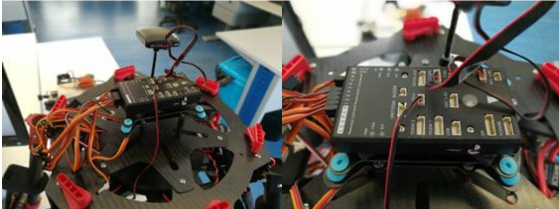
Figura 3.7: À esquerda: montagem do Pixhawk com GPS. À direita: zoom in em que é possível observar a “cama” com amortecedores (a azul), o LED principal que transmite informação ao utilizador do estado do Pixhawk; e seta a estar alinhada com o GPS.
