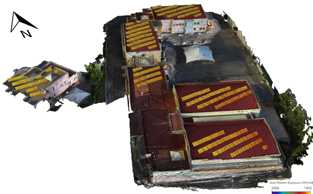
Figura 4.26: Perspetiva do complexo e distribuição de PV.
