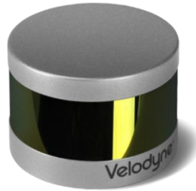
Figura 3.12: LiDAR PUCK VLP-16
