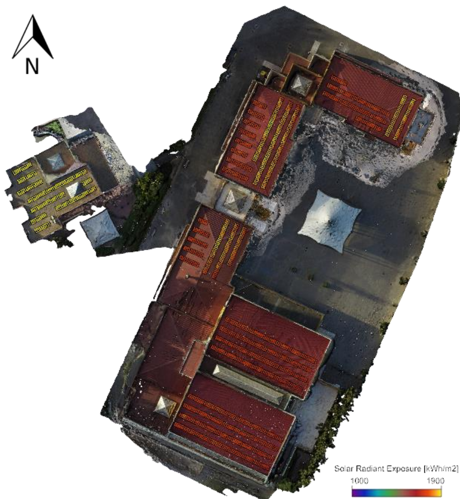
Figura 4.28: Sistema PV alternativo para o complexo considerando a maximização da produção PV.
