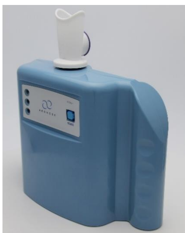
Figura 3. Aeonose™ - unidade diagnóstica para análise de COVs do ar exalado. Imagem reproduzida, com permissão, do site oficial da eNose Company®
