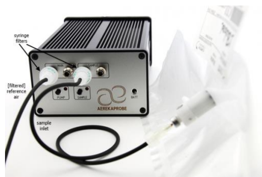
Figura 4. Aerekaprobe™ - unidade funcional do e.nose para análise de COVs do ar emanado por vários tipos de amostras. Imagem reproduzida, com permissão, do site oficial da eNose Company®
