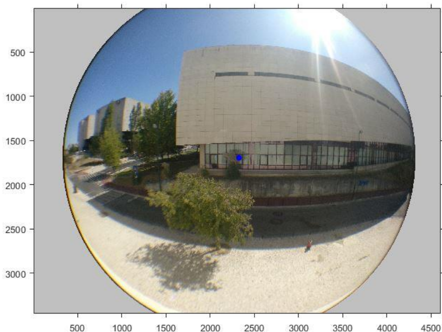
Figura 3.8: Determinação do centro da fotografia fisheye retirada no vão SSE 2 .
