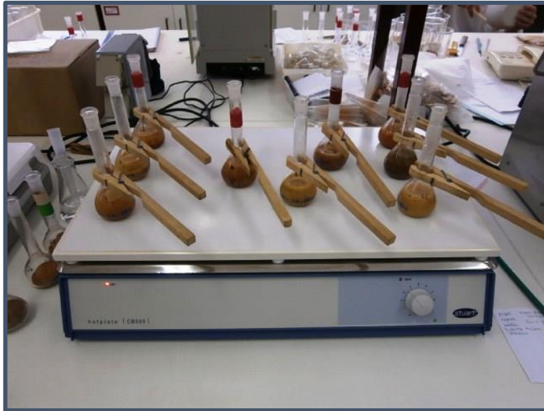
Figura 3.22: Ensaio de determinação da densidade das partículas.
