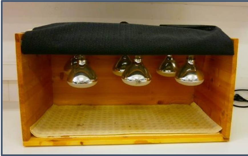
Figura 3.16: Câmara de radiação ultravioleta (UV) presente no Laboratório de Biogeoquímica Ambiental da Universidade de Évora.
