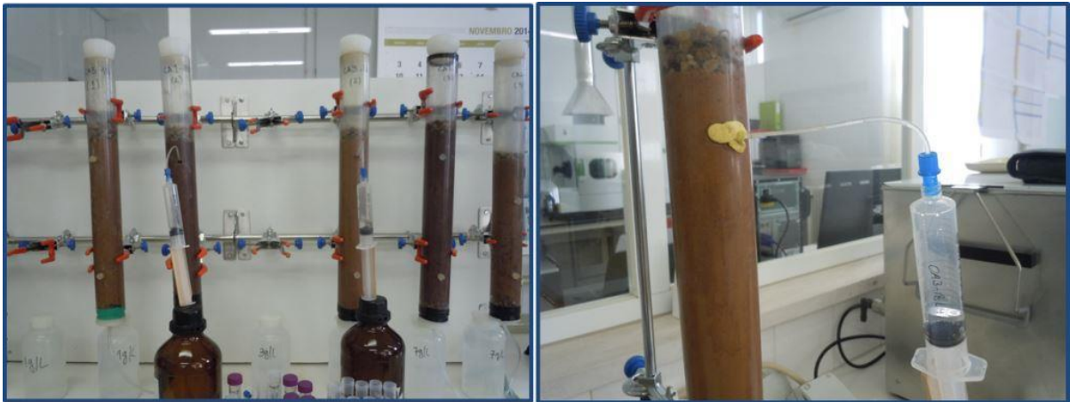
Figura 7.7: Extração da água intersticial antes da injeção com a solução de nanopartículas de ferro zero valente.
