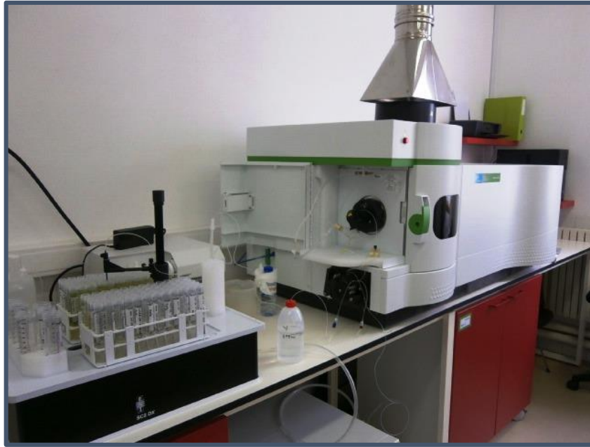
Figura 3.15: Espectrómetro de emissão óptica por fonte indutiva de plasma (ICP-OES) do Laboratório de Biogeoquímica Ambiental da Universidade de Évora.
