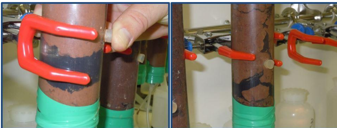
Figura 7.13: Aglomerações de nZVI formadas nas colunas durante o ensaio laboratorial.
