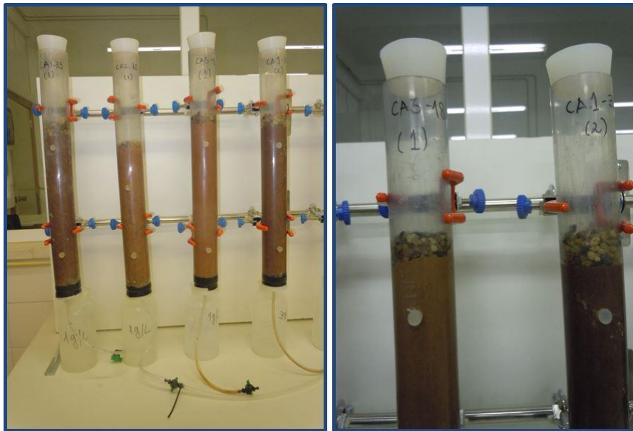
Figura 7.8: Montagem das amostras utilizadas no ensaio em coluna.
