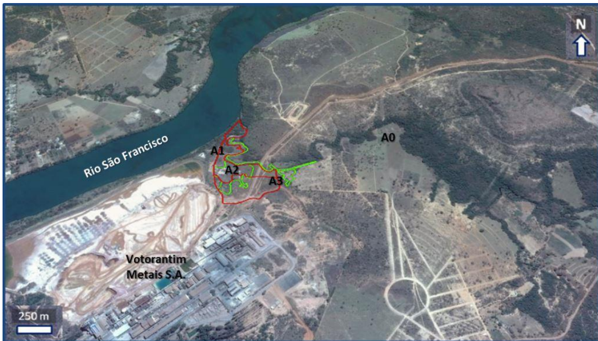
Figura 3.2: Áreas delimitadas como contaminadas (a verde) e degradadas (a vermelho) na área industrial da Votorantim Metais S.A. (Adaptado de Golder Associates , 2007b, Google Earth imagem de 20.08.2013 em 17.05.2016)
