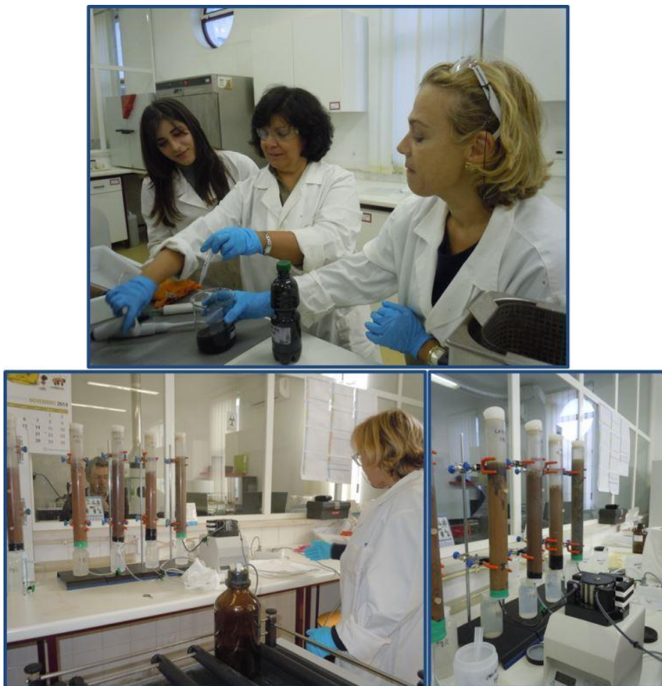
Figura 7.9: Preparação das soluções de ferro zero valente e injeção nas colunas de amostras.
