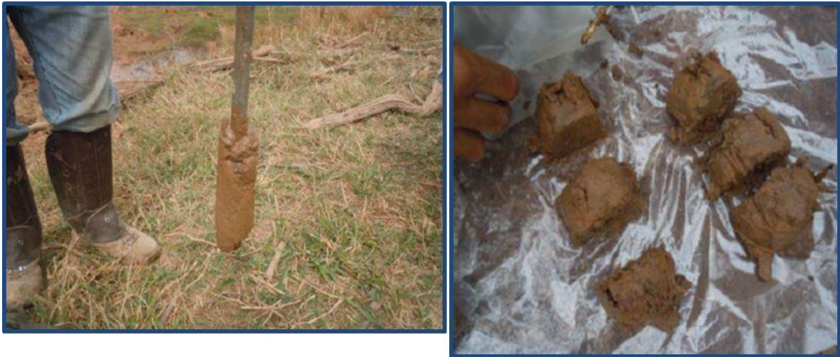
Figura 3.8: Amostragem de aluviões nas margens de acumulação do córrego com obtenção de amostras compósitas.
