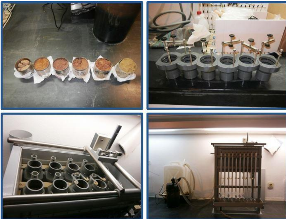
Figura 3.23: Amostras analisadas em anéis para determinação da permeabilidade e Permeâmetro do Laboratório de Geociências da Universidade de Évora.
