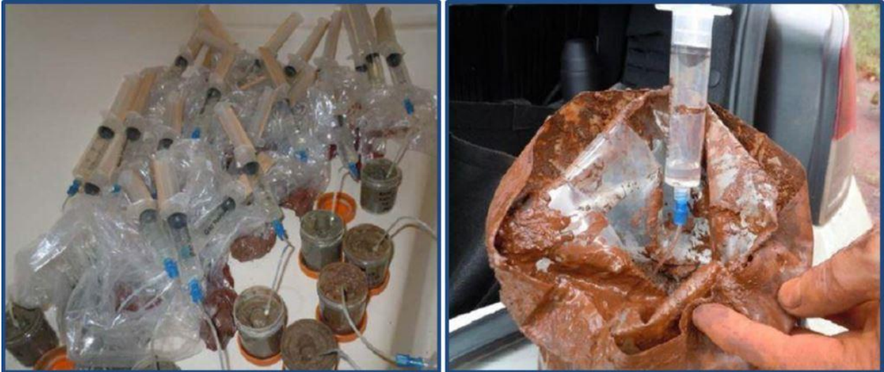
Figura 3.12: Amostragem de água intersticial com recurso a rhizom samplers .
