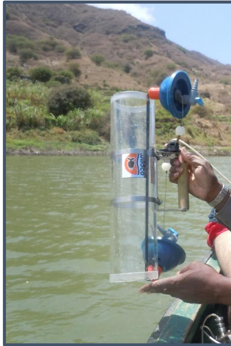
Figura 3.11: Recolha de água com recurso a uma garrafa de Van Dorn .
