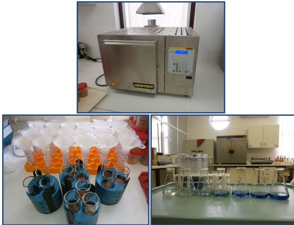
Figura 3.18: Mufla do Laboratório de Biogeoquímica Ambiental da Universidade de Évora (imagem superior) e diferentes etapas do ensaio de determinação de fósforo total.
