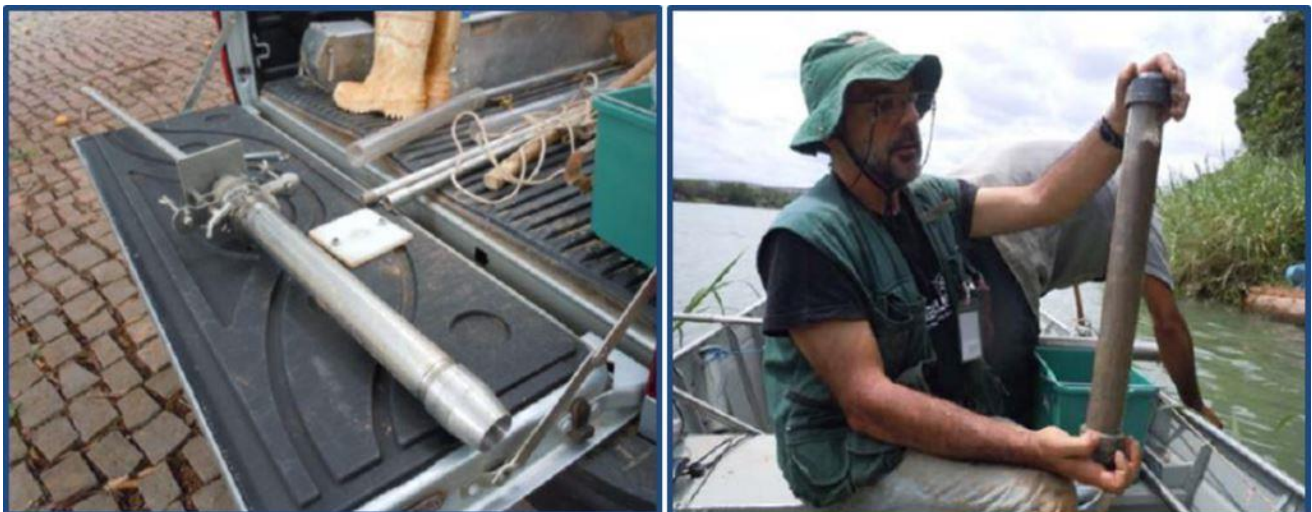
Figura 3.10: Amostragem em coluna dos sedimentos depositados no leito do córrego com recurso a corer de varas Kajak .
