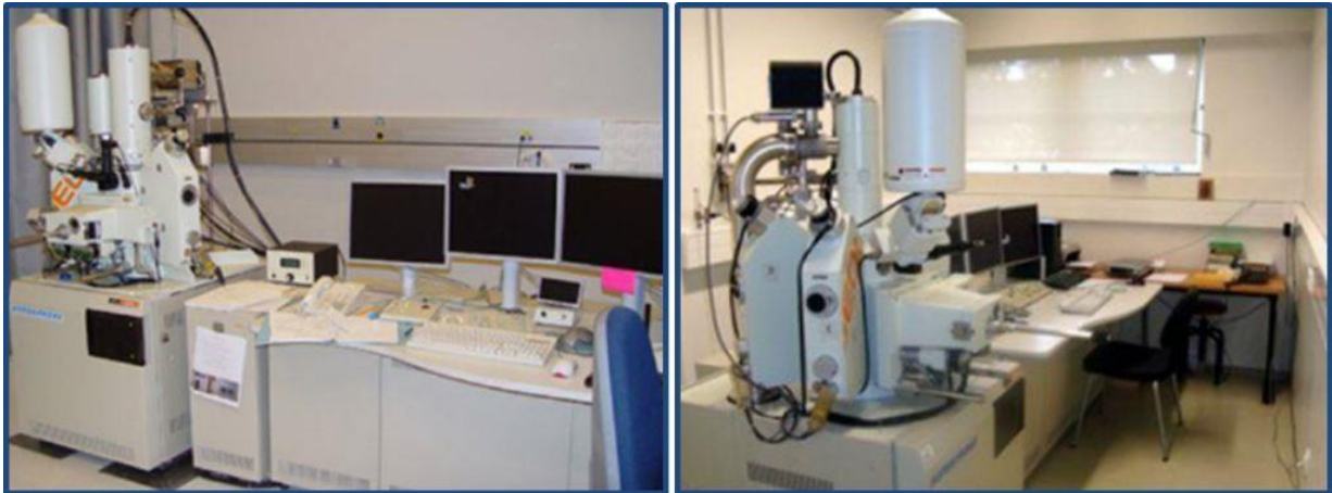
Figura 3.26: Micro-sonda electrónica presente nas instalações de S. Mamede de Infesta do LNEG, utilizada no estudo petrográfico.
