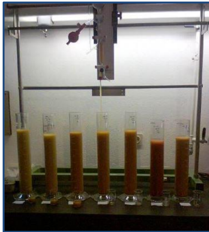
Figura 3.21: Pipeta de Andersen do Laboratório de Geociências da Universidade de Évora.
