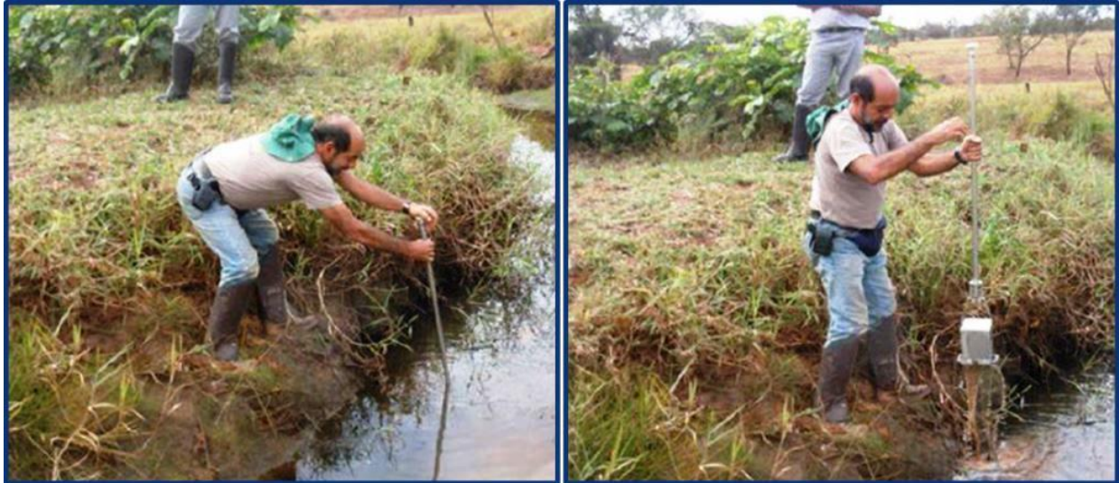
Figura 3.9: Amostragem de sedimentos imersos nas margens do córrego com recurso a draga manual do tipo Shipeck (com vara).
