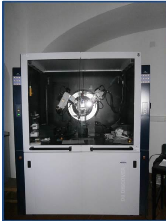
Figura 3.24: Difractómetro de Raios-X do Laboratório Hércules - Herança Cultural, Estudos e Salvaguarda da Universidade de Évora.
