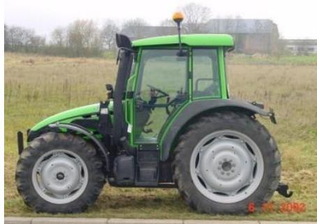
O tractor tem 2.2m de distância entre-eixos (*wheel base*) e pesa 24.5kN (*tractor weight*), sem lastro (*ballast*), estando o centro de gravidade a 0.80m do eixo traseiro (*rear axle*).
