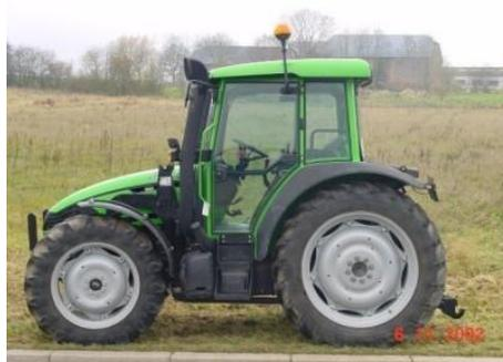
Bastará colocar sucessivamente o eixo frontal e o eixo traseiro sobre o tabuleiro da báscula, medindo-se, desta forma,  $R_f$  e  $R_t$ , respectivamente.
