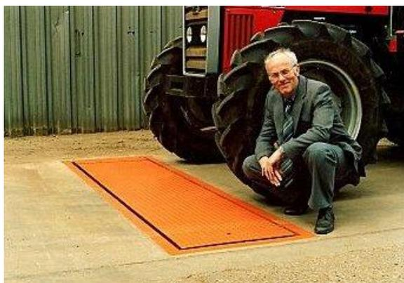
A colocação de qualquer eixo sobre o tabuleiro permitirá a medição da reacção que o solo efectua sobre esse eixo (ou seja da acção que o eixo faz sobre o solo).
