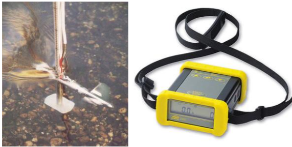
Figura 5.3. Molinete de hélice e contador de rotações.
