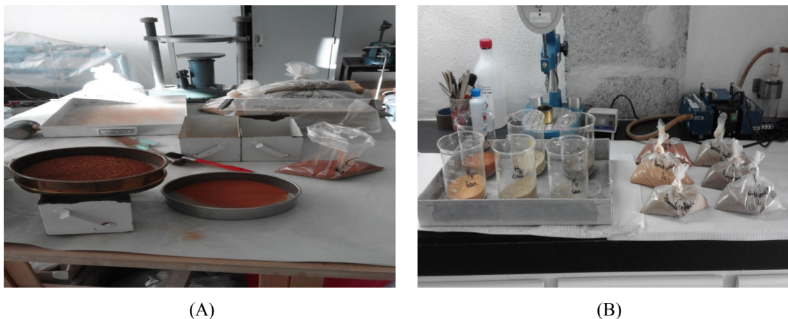
Fig. 2 - Preparação geral das amostras de solos no laboratório: (A) Repartição dos solos; (B) Análise granulométrica dos provetes de solos.
