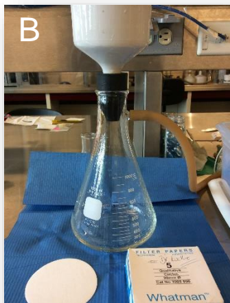
Fig.11 Elaboración de extracto de clavo: A) Ebullición por 5 minutos de clavo molido en 100mL de agua, B) Filtración, C) Extracto. Fuente: directa.
