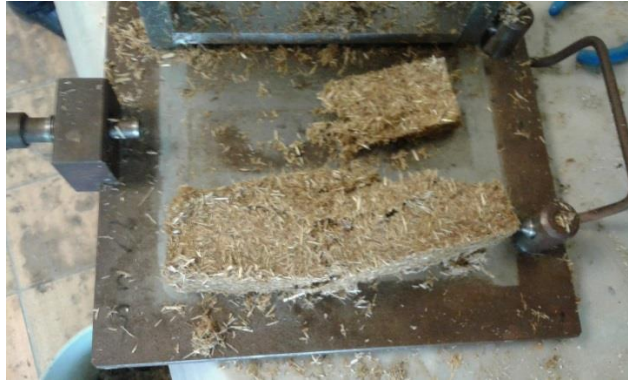
Imagen 4. 11 Mezcla fallida de proporciones 60/40 resina/paja
