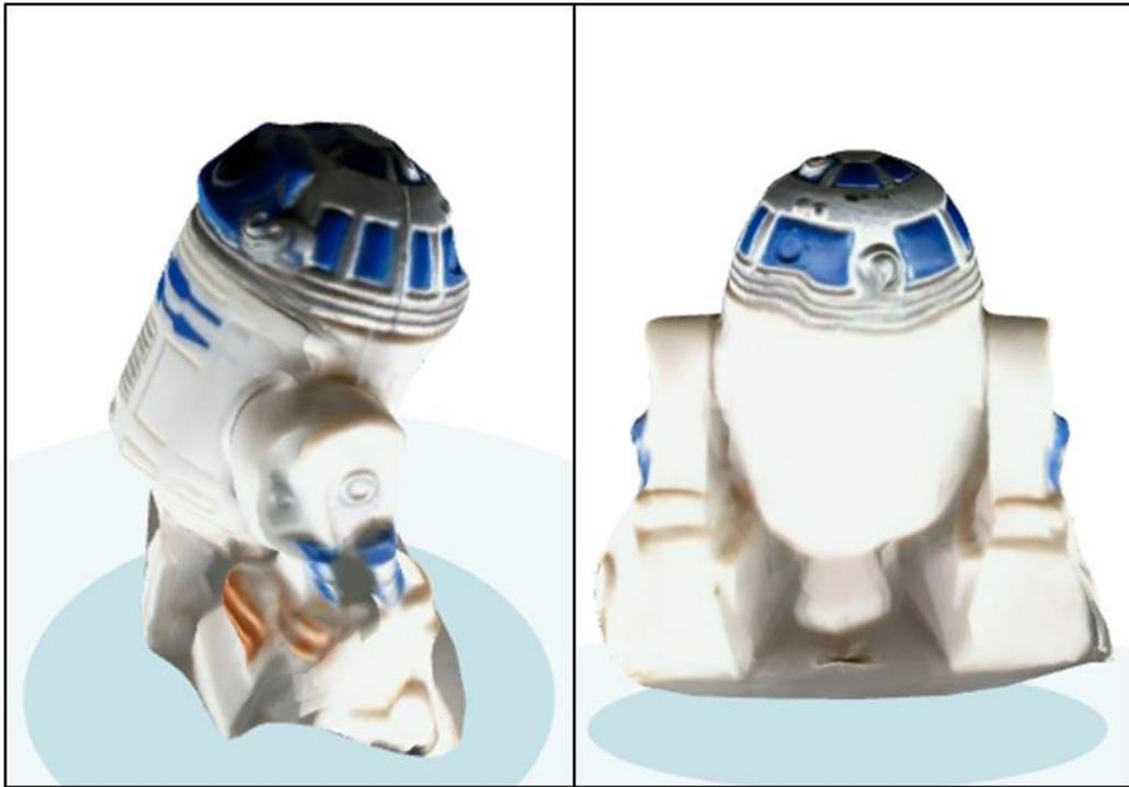
*Figura 8.7 Resultado obtenido durante la segunda prueba mediante el uso de ReMake.*
