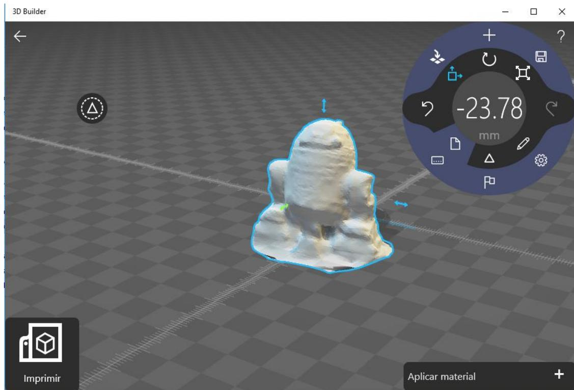
Figura 7.11 Modelo generado por MeshRecon a partir de la nube de puntos proporcionada por VisualSFM.
