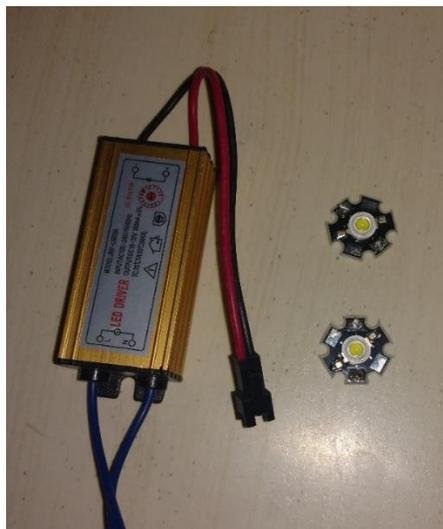
Figura 5.7. Leds de potencia y fuente de alimentación de 12V con capacidad para 9 leds.
