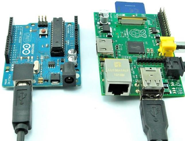
*Figura 1.11. Plataformas de Hardware Libre Arduino UNO y Raspberry Pi.*
