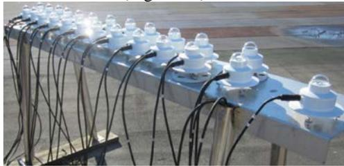
**Fig. 10.** Radiómetro UV-BIOMETER.
