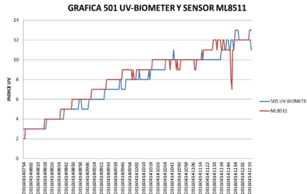
**Fig. 11.** Gráfica comparativa de mediciones ML8511 vs UV-BIOMETER
