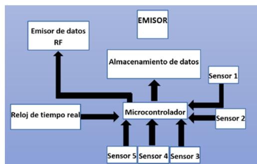
Fig. 2. Diagrama a bloques del emisor.
