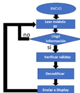
Fig. 7. Diagrama de flujo del receptor
