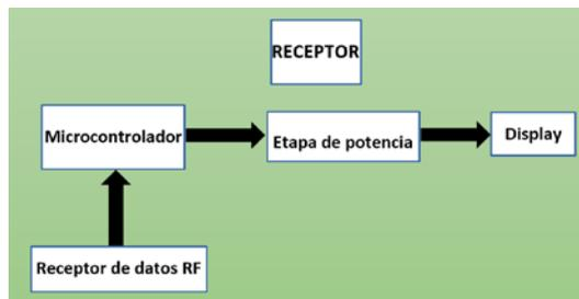
Fig. 4. Diagrama a bloques del receptor
