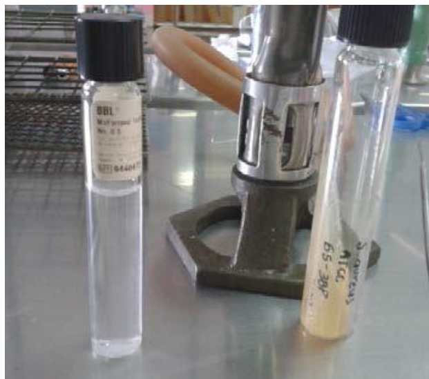
Imagen 2. McFarland No. 0.5 y cepa de S. aureus ATCC 6538.P, con la que se realizó la suspensión bacteriana.
