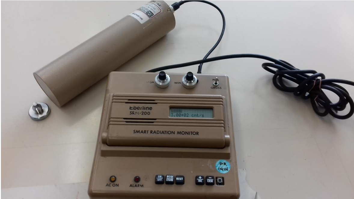
Fig. 3.1 Sistema de Radiación Monocanal modelo SRM-200 ( Smart Radiation Monitor, Eberline Thermo instrument systems Inc. ).
