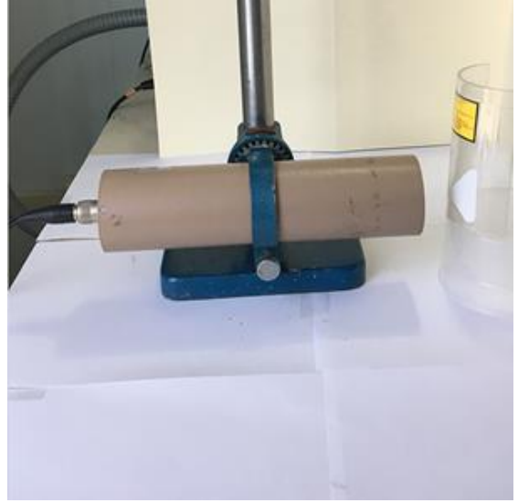
Fig.4.13 Geometría fuente-detector del sistema de detección.
