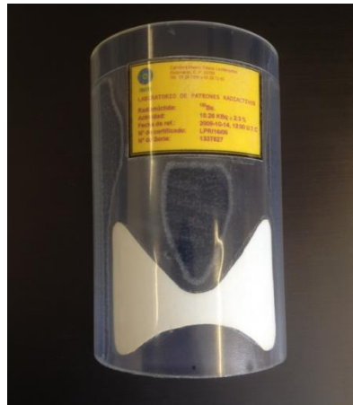
Fig. 3.2 Maniquí de tiroides con Fuente de ^{133}\text{Ba}
