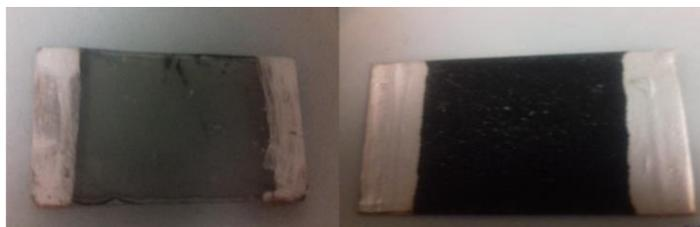
**Figura 4.1** Fotografías de capas de diferentes números de depósitos. a) Un depósito, b) 5 depósitos.
