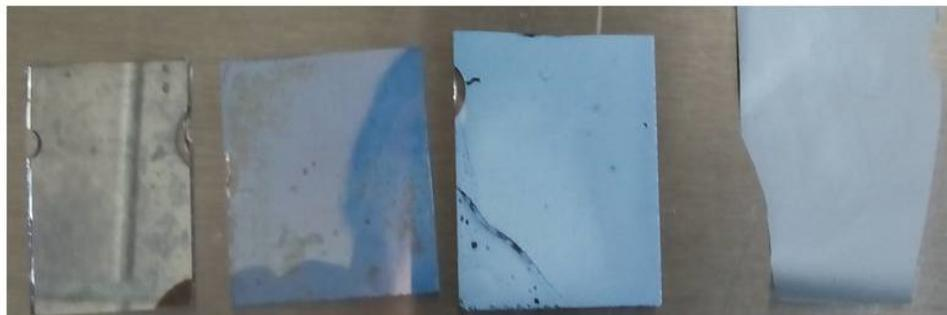
Figura 15. Depósitos de Zn de distinto espesor. De izquierda a derecha se muestra: a) M12 que se obtiene cuando se detiene la deposición justo en el momento en que se forma la primera capa conductora con ayuda del osciloscopio, b y c) M11 obtenidas al medir la resistencia eléctrica in situ y d) M6 que se obtiene después de una hora de deposición metálica.
