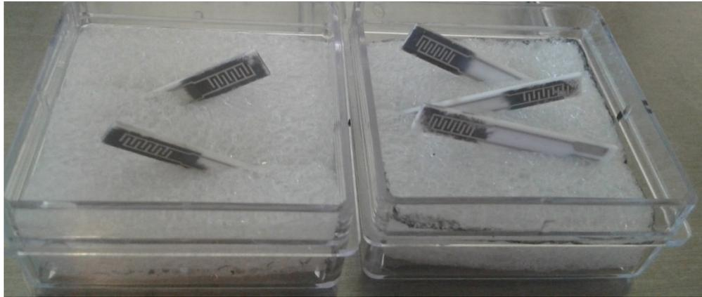
Figura 56. Zn metálico depositado sobre contactos interdigitados antes del tratamiento térmico.
