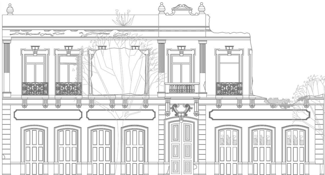
Figura 103. Daños en Inmueble con Vegetación Existente
