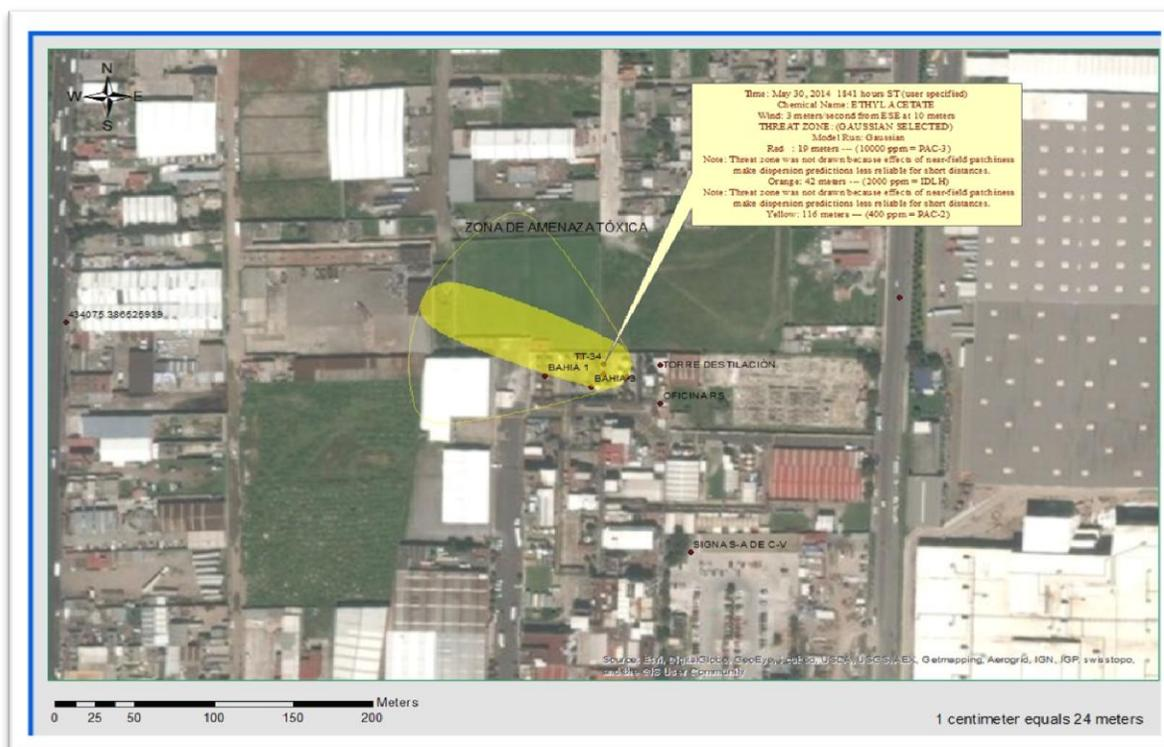
**Figura 26. Modelo de dispersión para acetato de etilo en la bahía de tanques en ArcGIS.**
