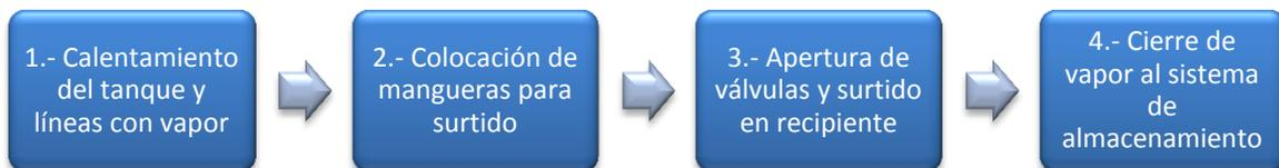
**Figura 19. Diagrama de flujo de la operación de surtido de ácido acético glacial.**
