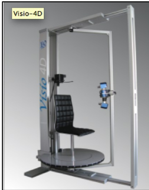
Figura 3.6 Banco de posicionamiento Visio 4D utilizado para capturar las imágenes 3D de la textura y topometría de la piel.
