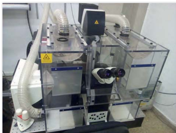
Figura 9. Microscopio láser confocal SP5 de Leica (izquierda). Equipo para la observación y toma de microfotografías del microscopio confocal (arriba).
