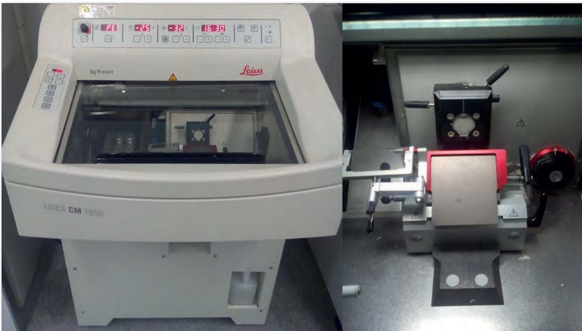
Figura 8. Criostato Leica CM 1950 (izquierda). Detalle de la platina de corte (derecha).
