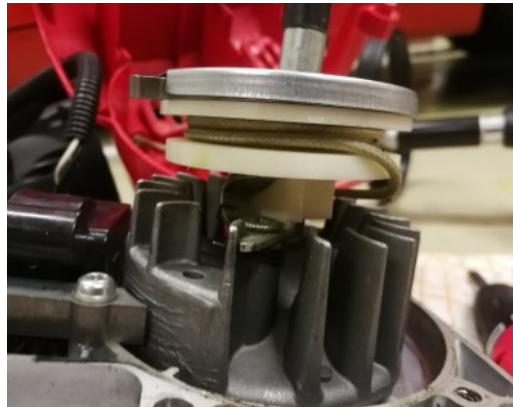
Kuva 21. 3D-tulostettu ratas asennettuna.
