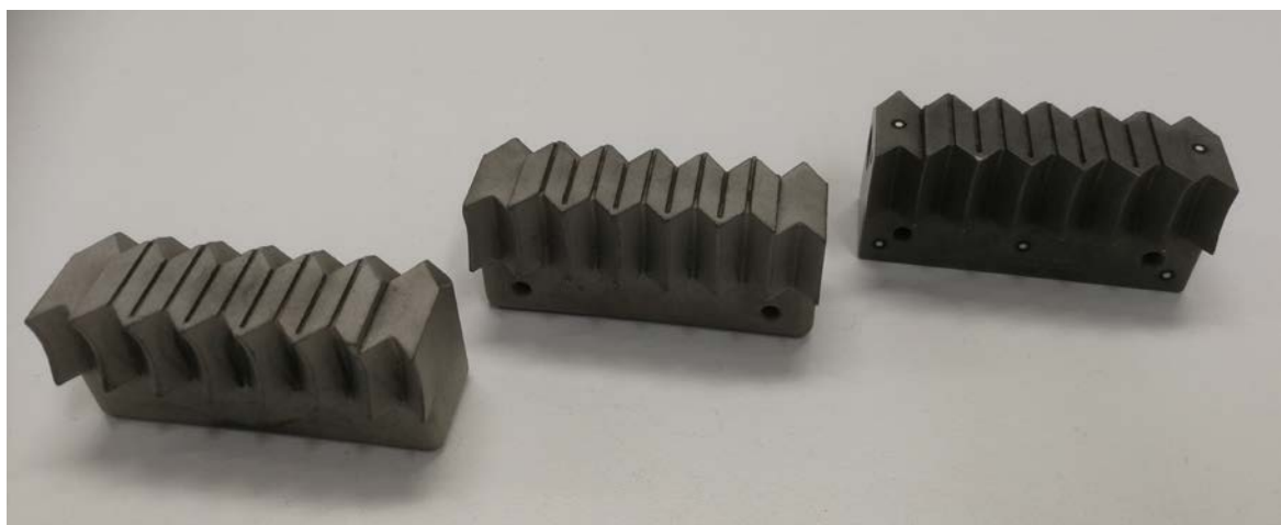
Kuva 9. Lämpölevyosat tarkkuusvalun eri vaiheissa: Vasemmalla valettu, keskellä koneistettu ja nitrattu, oikealla koneistettu ja karkaistu.
