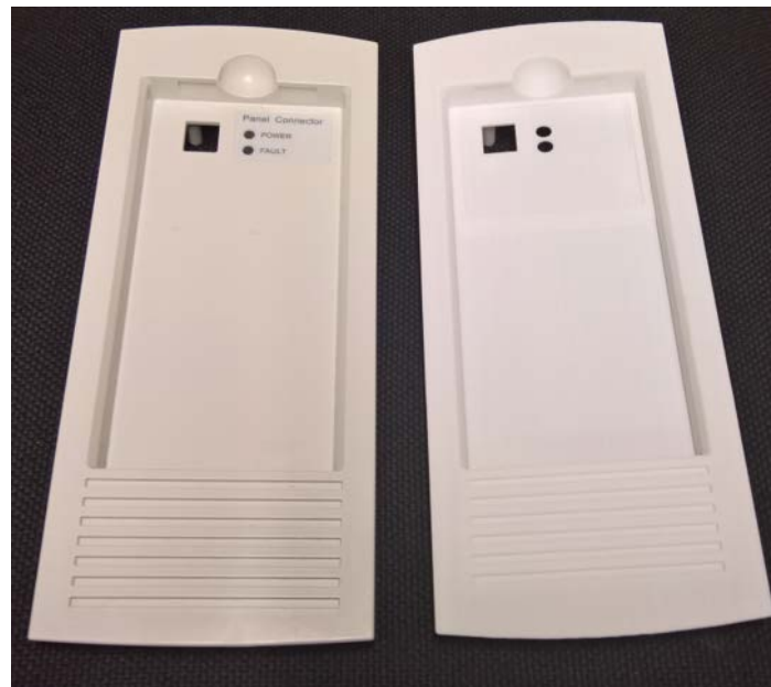
Kuva 24. Ruiskupuristettu elektroniikkakotelo vasemmalla ja lasersintrattu oikealla.
