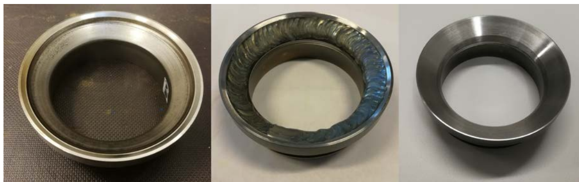
Kuva 12. Alkuperäinen seetirengas, kappale suorakerrostuksen jälkeen ja viimeistelty kappale.
