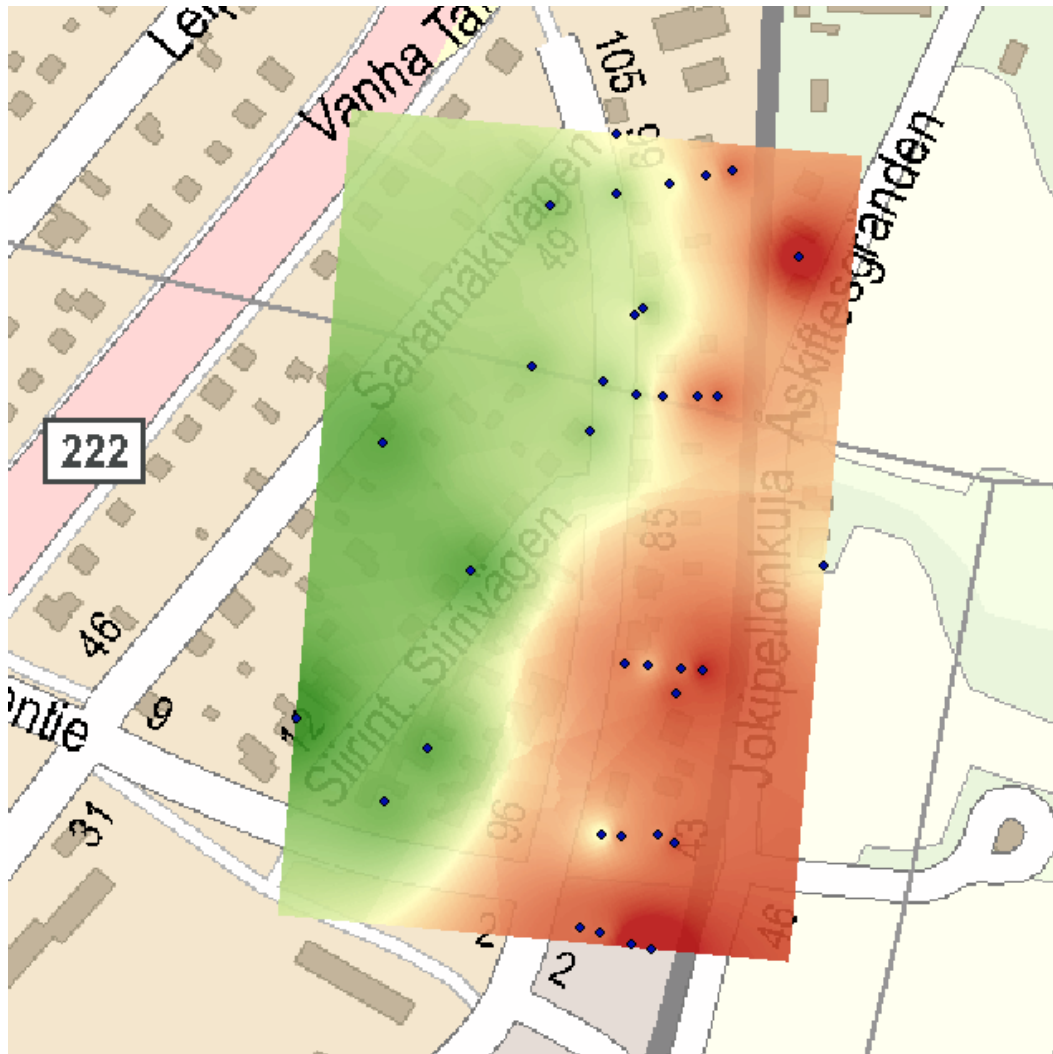
Kuva 7.2. Maan pystysuoran värähtelyn tunnusluvun tasa-arvokäyrästä sekä mittauspisteet.
