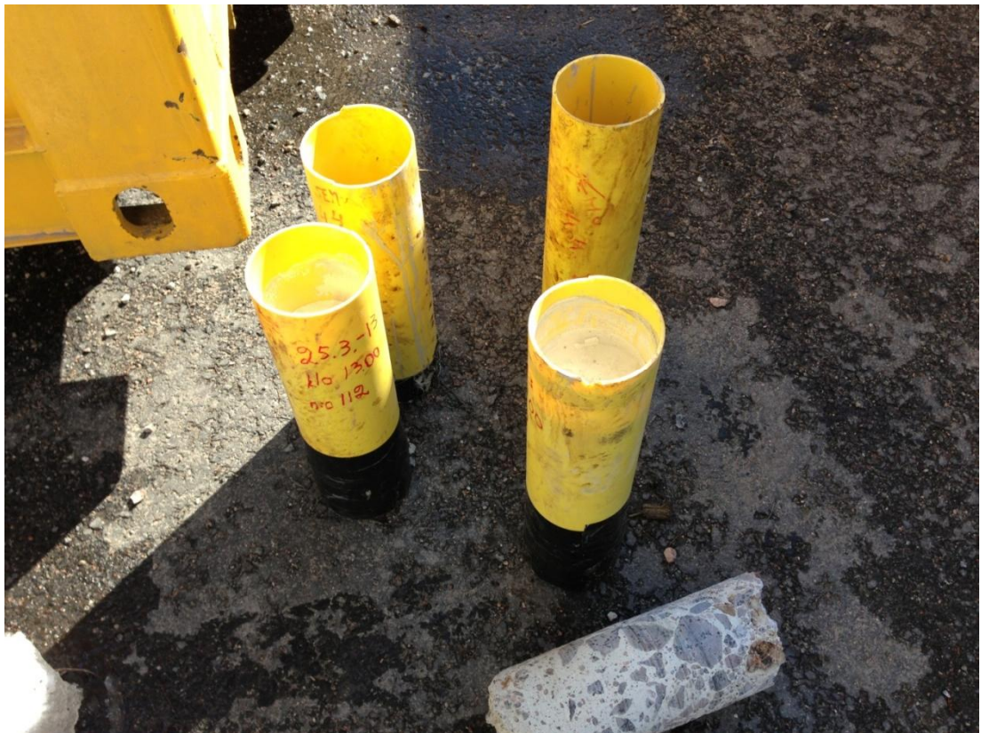
Kuva 31: Valunäytteet ja poranäyte ennen puristuskokeiden suorittamista.
