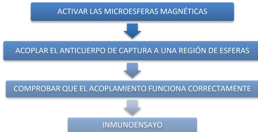
Figura 12: Esquema del flujo del trabajo para llevar a cabo un inmunoensayo con la tecnología xMAP de Luminex.
