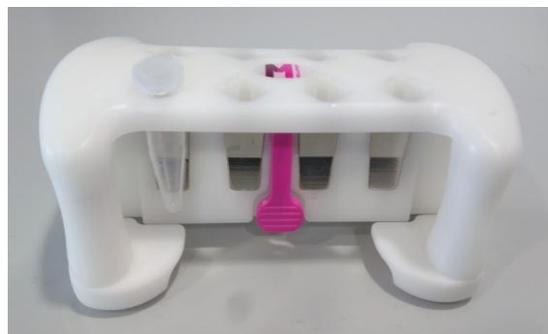
Figura 13: Soporte imantado para lavados de tubos (tipo eppendorf).
