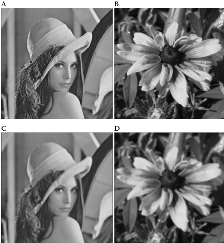
Joonis 2.5 — Keskmistamine rakendatuna “libiseva naabruse” operatsioonina piltidele “Lena” ja “lill”, kui bloki suurus on 3 \times 3 pikslit (A) ja (B) ning 7 \times 7 pikslit (C) ja (D)
