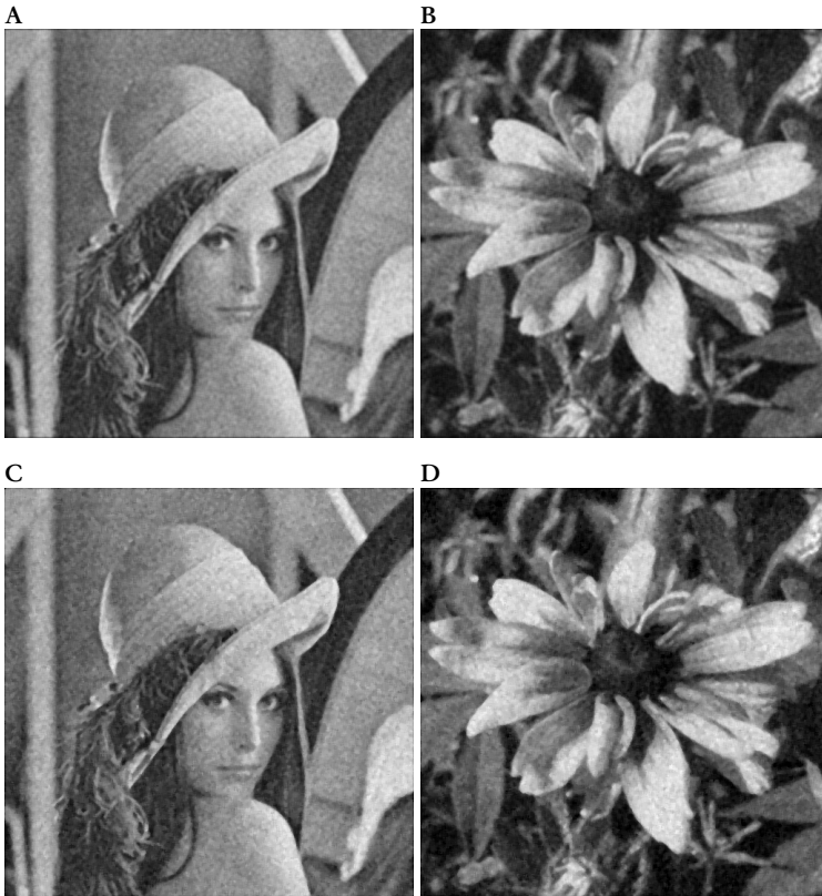
Joonis 2.10 — Gaussi jaotusega valge müraga pildid, mida on filtreeritud madalpääsfiltriga: “Lena” (A) ja “lill” (B); ning mediaanfiltriga: “Lena” (C) ja “lill” (D)
