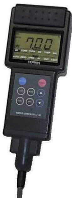
Fig. 11. Painel de uma sonda multi-sensor para análises de alguns parâmetros de qualidade de água in situ .
