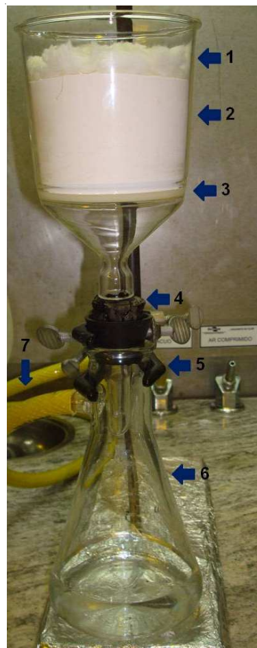
Figura 1. Sistema para filtração à pressão reduzida. (1) lã de vidro; (2) leito de alumina neutra; (3) funil de vidro com placa sinterizada; (4) adaptador de borracha; (5) garra com suporte universal; (6) kitassato e (7) mangueira de vácuo.
