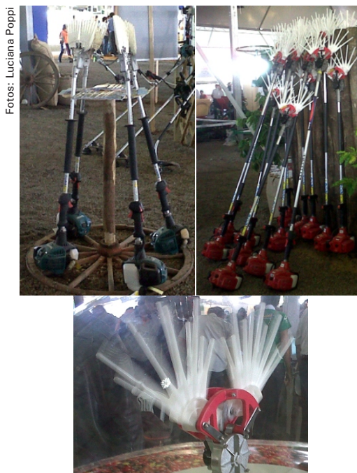
Figura 1. Fotos de derriçadeiras portáteis de grãos de café e do funcionamento das varetas que são responsáveis pela derriça dos frutos.
