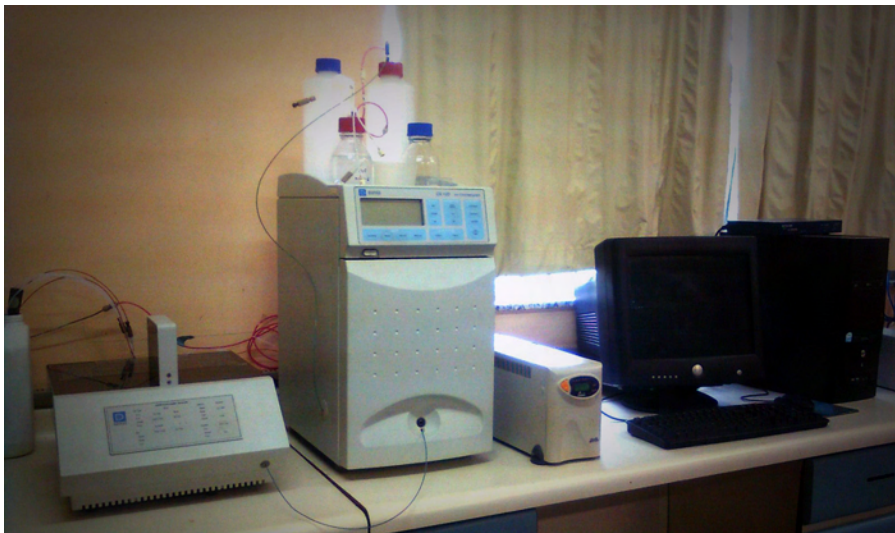
Figura 3. Cromatógrafo iônico para determinação dos principais cátions e ânions dissolvidos em amostras de água.
