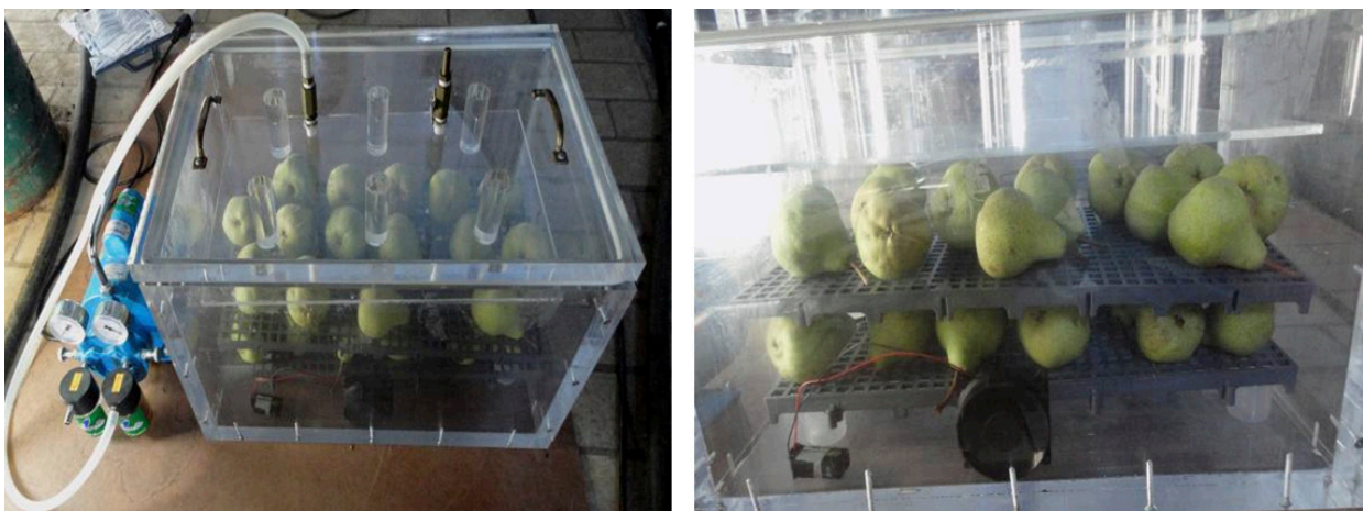
Fig. 4. Caixa de acrílico fechada, conectada a uma bomba de vácuo e provida de mini ventilador, contendo peras dispostas sobre estrado plástico modular.
