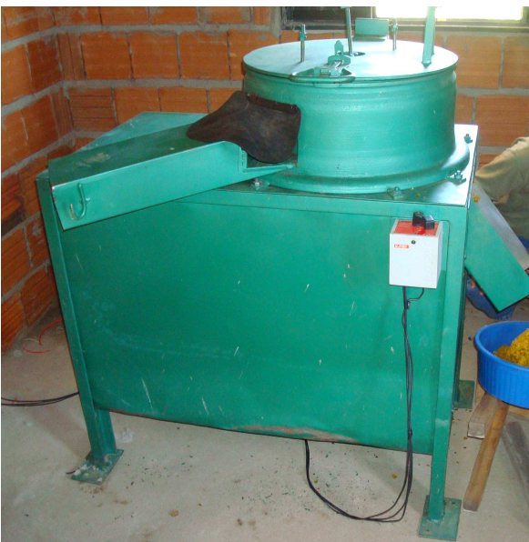
Figura 1. Despoldadora utilizada na extração mecânica da polpa da bocaiuva.
