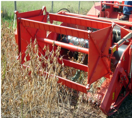
Foto: Lília Sichmann Heiffig-del Aguila Figura 1. Mecanismo de corte e alimentação de uma colhedora de soja.
