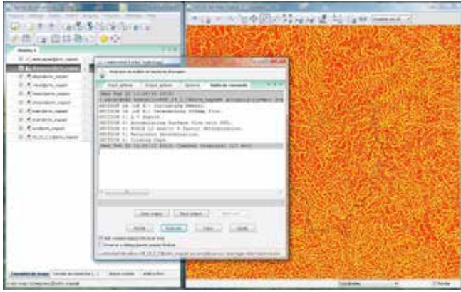
Figura 15: Saída de comandos do módulo r.watershed mostrando os procedimentos que foram feitos e o tempo gasto pelas análises e para gerar os mapas (8 mapas em 13 segundos).
