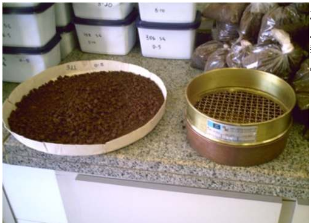
Figura 2. Amostra de solo preparada para determinação da agregação após manipulação para transpassar a peneira de 9,52 mm.
