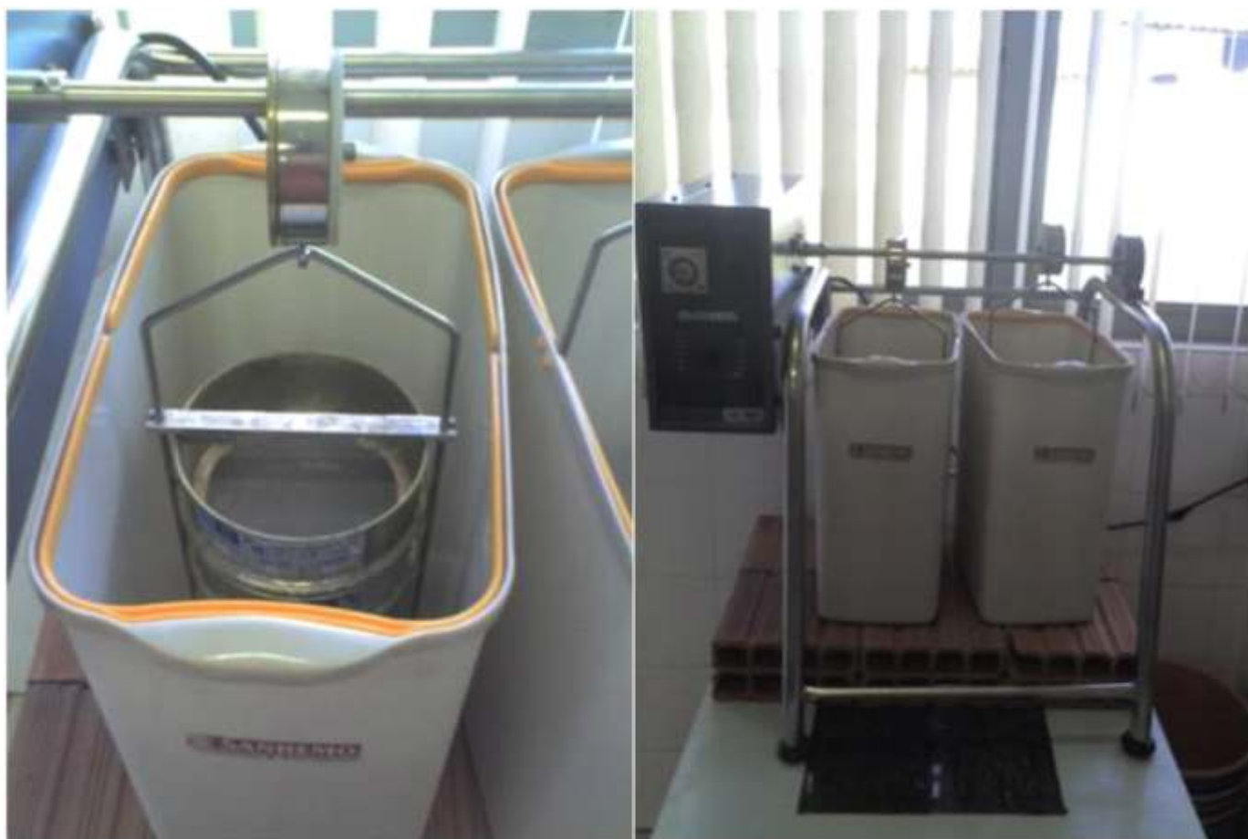
Figura 7. Equipamento utilizado para realização do peneiramento em água.
