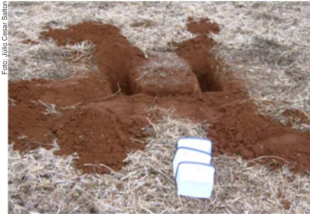
Figura 1. Procedimento utilizado para coleta de monólitos para determinação da agregação do solo.
