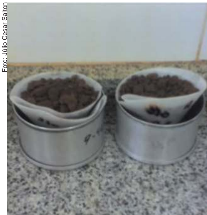
Figura 6. Esquema para umedecimento por capilaridade das amostras para determinação da agregação via úmida.
