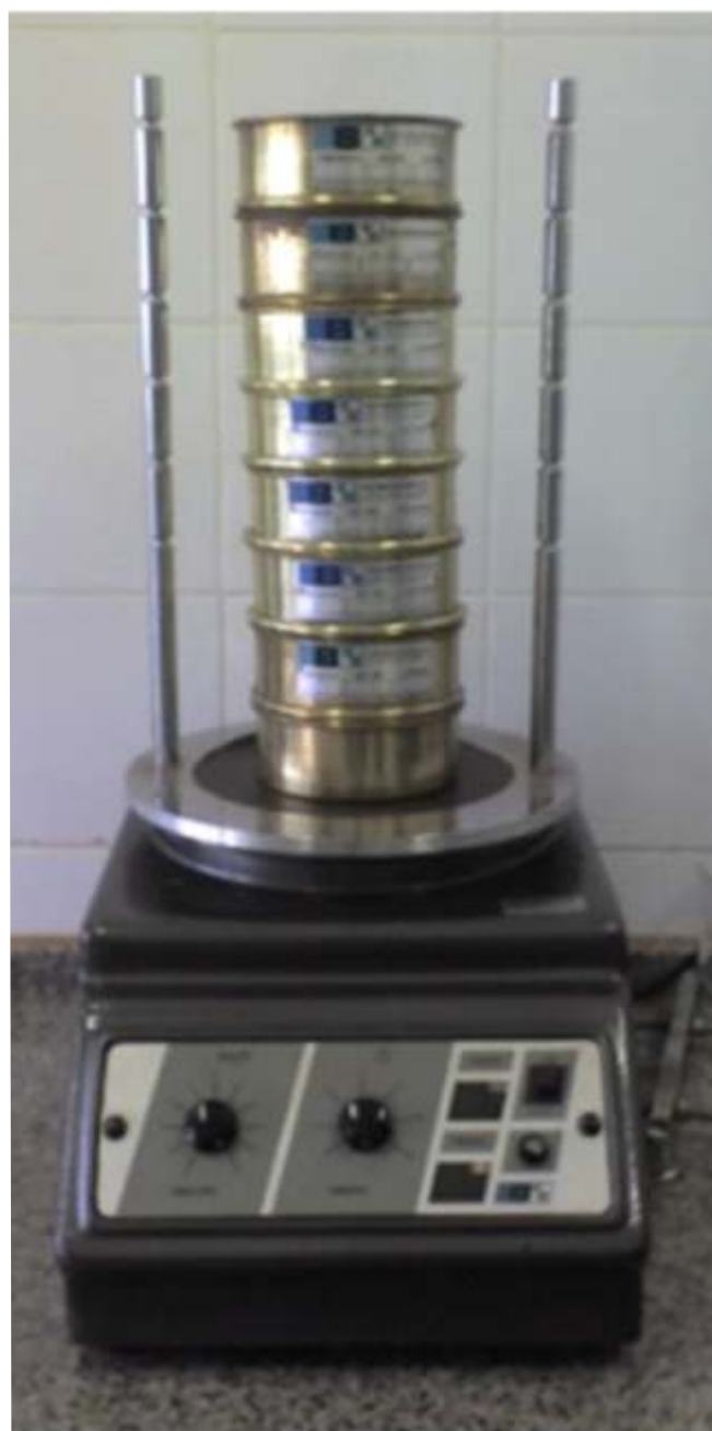
Figura 4. Agitador mecânico vibratório, marca Solotest, utilizado para peneiramento das amostras "a seco".
