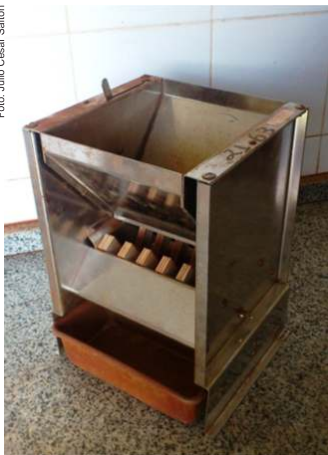
Figura 3. Quarteador tipo Jones utilizado para obtenção de amostras homogêneas do solo.
