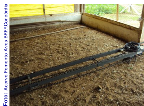
Figura 5. Calha mecânica para movimentação e elevação das caixas ao caminhão
