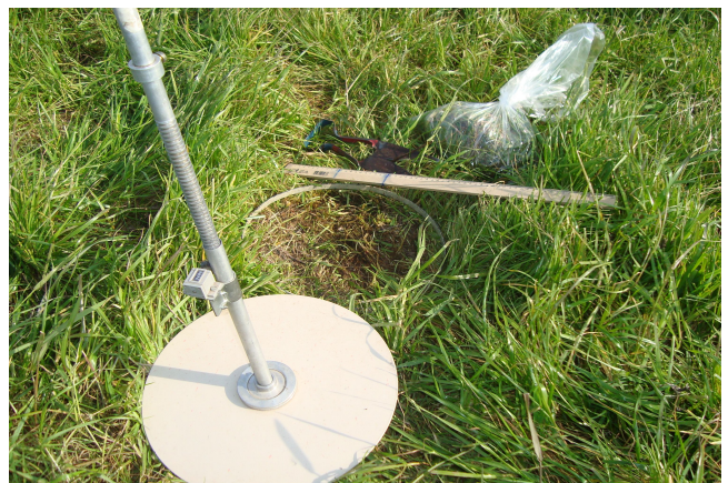
Figura 2. Disco de amostragem, aro, régua e tesoura utilizados para amostragem da massa de forragem do azevém anual. Estação Experimental Terras Baixas, Embrapa Clima Temperado, Capão do Leão, RS, 11 de agosto de 2010.
