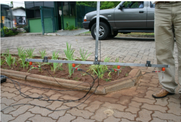
Figura 4: ilustração do suporte das hastes de medida de condutividade elétrica.
